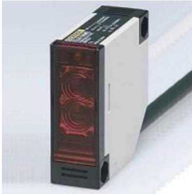
Este sensor infrarrojo de barrera (reflectivo) detecta la presencia de una persona o un objeto que interrumpe el haz de luz que pasa a través de su trayectoria. Normalmente se utiliza para la seguridad, la notificación de entrada ó salidas, incluso para domótica y la puesta en marcha de algún dispositivo a la activación. El transmisor emite un haz de luz invisible o infrarroja a través del aire a lo largo de una trayectoria deseada.
